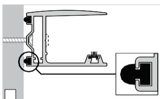
Senkrechte Führungsschiene (60 x 42 mm) mit 2D-Ausrüstung zum Ausgleich von Wandunebenheiten.
