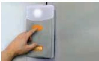
Steuerung für Wandmontage mit integrierter Beleuchtung
